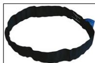
Das Benutzen von reinen Polyesterrundschlingen setzt zwingend das Brücken mittels eines Drahtseiles voraus. Rundschlingen mit Stahleinlage („Steelflex“) benötigen kein gesondertes Stahlsafety.
